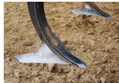
▲ Les outils à ailettes sont adaptés à la lutte contre le chardon en conditions sèches.
