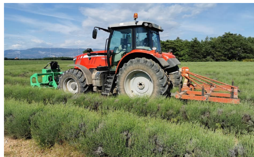
Broyeur double inter-rang de la coopérative SCA3P attelé à l'avant, et bineuse avec lames Bathelier attelée à l'arrière, chez Denis Vernet (04) (crédit photo : Denis Vernet)
