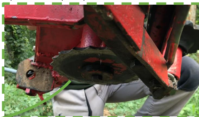
Disque à dent (sectionne la liane)
