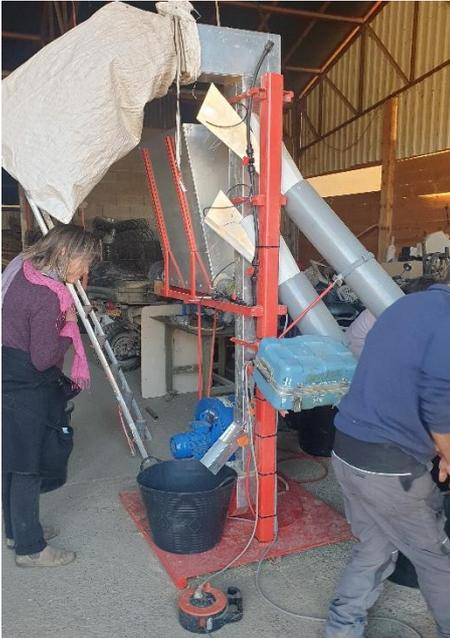
Figure 7 : colonne densimétrique auto-construite
