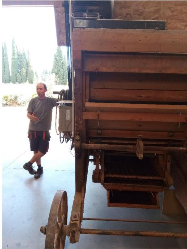
Tri : matériel d'occasion. 2 plaques l'une au-dessus de l'autre. Nécessité de faire plusieurs passages généralement. Temps de travail : 60 kg/h pour le thym.
