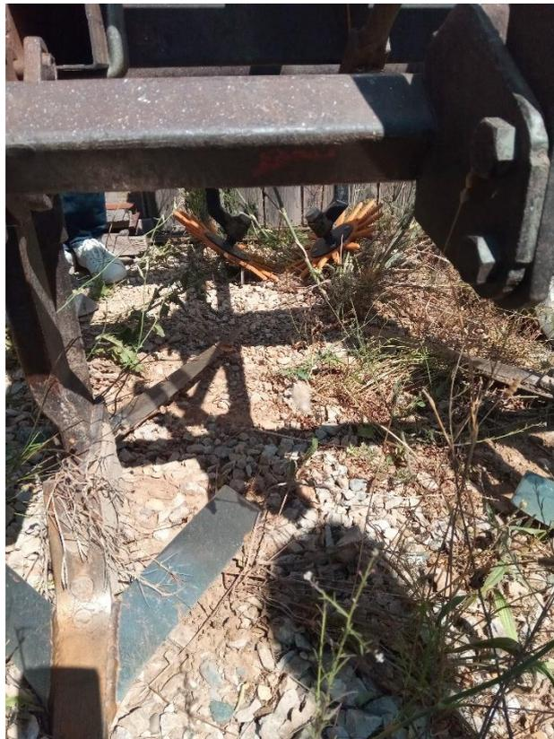
Faucheuse auto-chargeuse : récolte en déporté. Il manque des releveurs, visible sur la parcelle récoltée de verveine où il reste des branches sur les côtés des plants → trop de pertes. Même problème sur le romarin ; sans releveurs la faucheuse roule sur le bord des plants quand ils s'élargissent.
