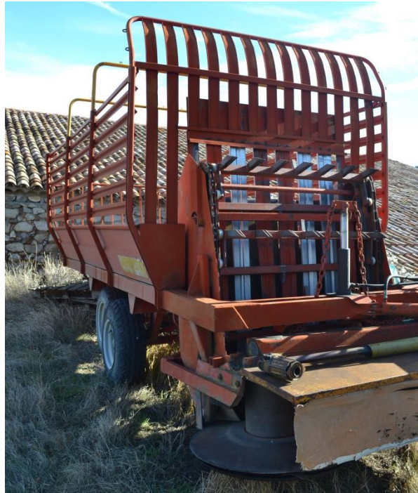
Figure 5: Faucheuse auto-chargeuse (à foin) pour la récolte
