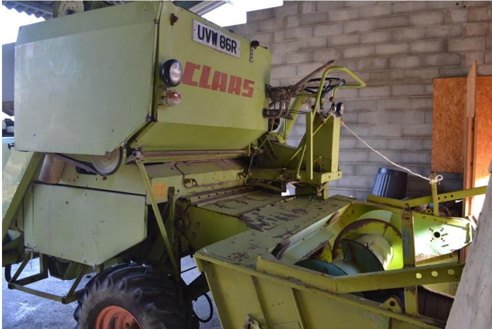
Figure 7: Moissonneuse-batteuse adaptée pour le battage des PPAM
