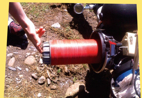
UN FILTRE À LAMELLE, FILTRATION À 130 MM
