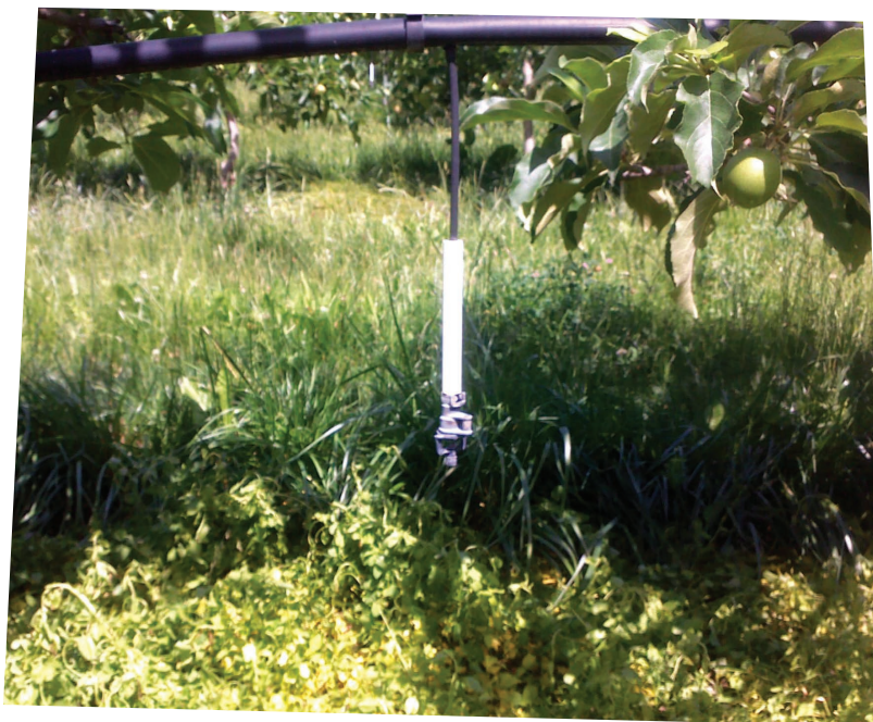
UN MICRO-JET, POSITIONNÉ EN « PENDOUILLE » À 30 CM AU-DESSUS DU SOL
