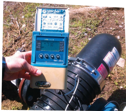
UN PROGRAMMATEUR À PILE POUR PILOTER LES IRRIGATIONS
