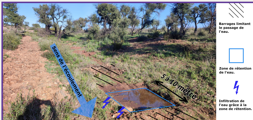
Schéma du design hydrologique des fossés
