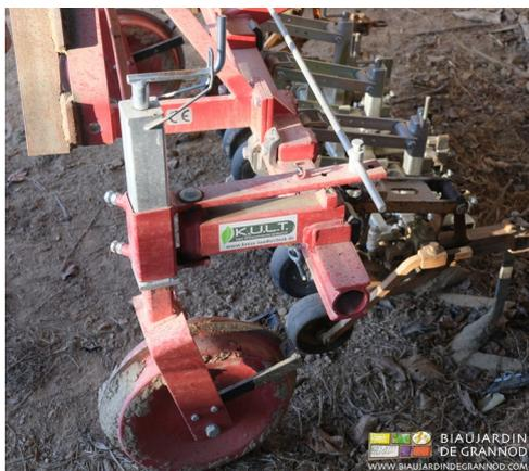
Système « subtil » : Un châssis primaire, sur lequel est fixé le siège, est attelé au tracteur ; il porte sur le sol par des roues fixes.
