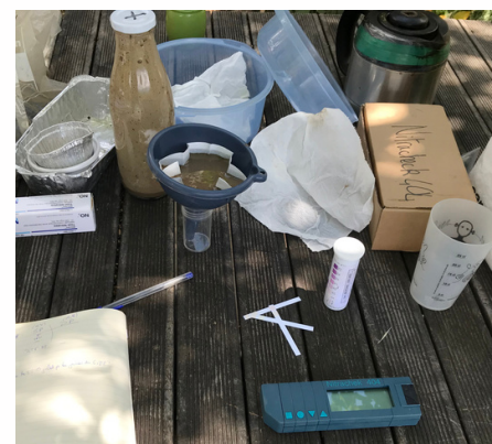
Test nitrate et lecture des bandes par Nitratecheck (Crédit photo : Agribio06)
