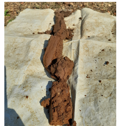
Observation de prélèvements à la tarières sur 50 cm de profondeur. (Crédit photo : Agribio06 et Agribio83)
