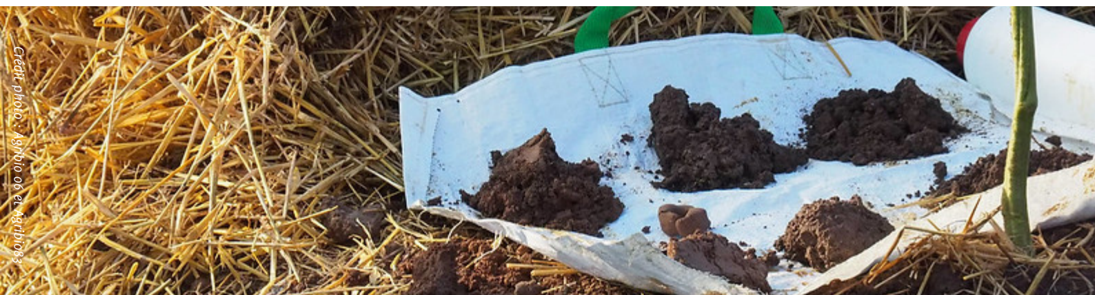
Observation de prélèvements à la tarières sur 50 cm de profondeur. (Crédit photo : Agribio06 et Agribio83)
