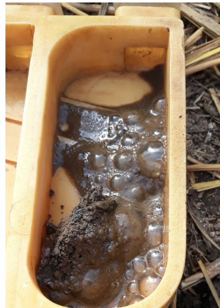
Résultats d'un test à l'acide chlorhydrique sur sol calcaire (Crédit photo : Agribio06)
