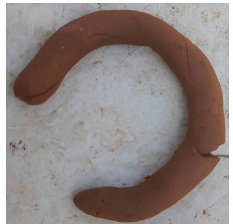
Test du boudin : taux d'argile estimé à 15-20% d'argile. (Crédit photo : Agribio06)
